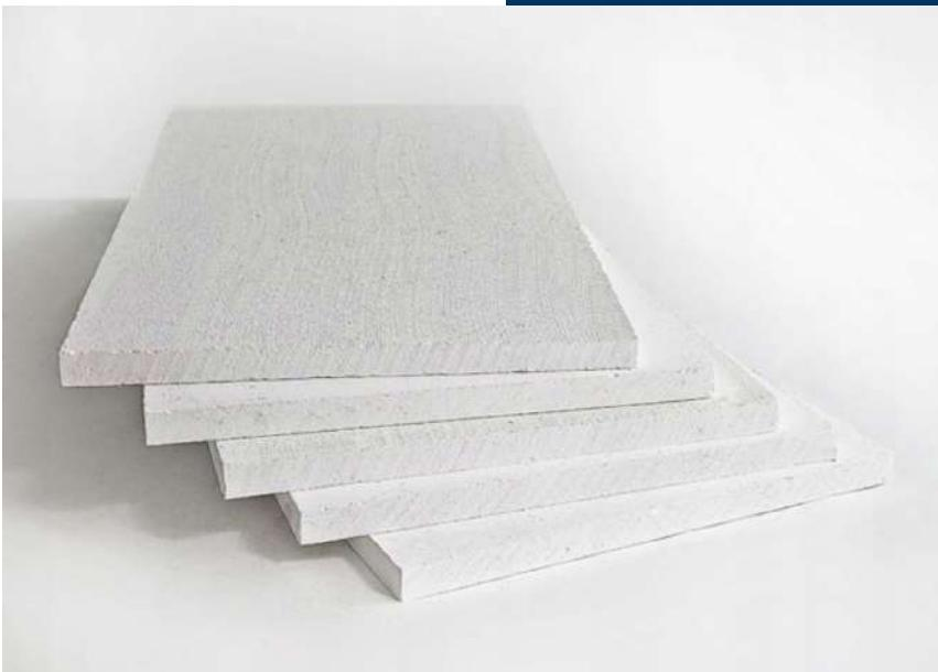
композит плиталарни ишлаб чиқаришга имкон беради ва шу билан монтаж ишларини соддалаштиради. Силикат композит плиталарнинг қалинлиги - 30 дан 100 мм гача; узунлиги - 1000 дан 2500 мм гача, кенглиги - 610 дан 1500 мм гача. Масалан, 1000x625x30 мм лик плитанинг оғирлиги атиги 4,7 кг, 1000x1250x40 мм - 12,5 кг ва 1500x1250x50 мм - 23,4 кг тенг.
